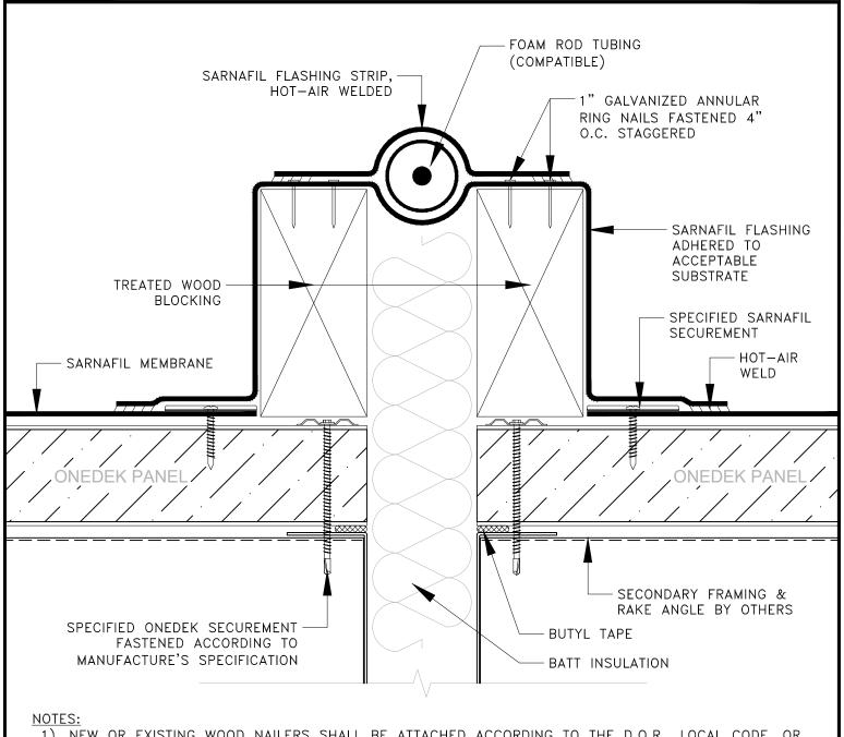
1) NEW OR EXISTING WOOD NAILERS SHALL BE ATTACHED ACCORDING TO THE D.O.R., LOCAL CODE, OR INSURANCE REQUIREMENTS, WHICHEVER IS MORE STRINGENT. NAILER HEIGHT TO MATCH TOP SURFACE TO WHICH MEMBRANE IS TO BE APPLIED.
