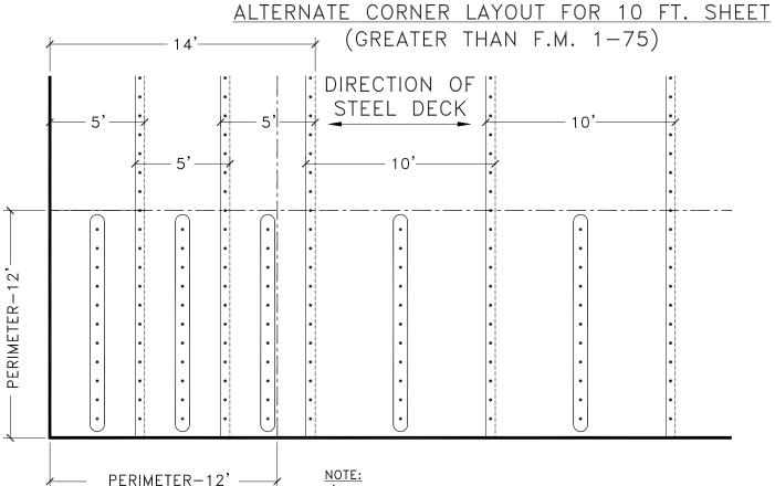
1) CORNER AREA INTERMEDIATE FASTENER ROWS TO BE INSTALLED MIDWAY BETWEEN THE HALF SHEET FASTENER ROWS.
