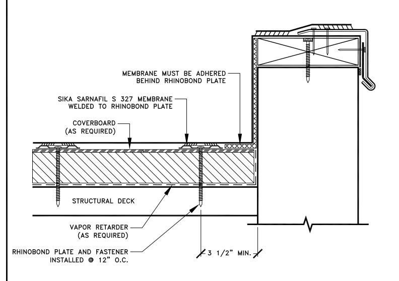
NOTES: DO NOT INSTALL RHINOBOND PLATES TIGHT AGAINST WALL. THE RHINOBOND WELDER IS 7" WIDE AND MUST BE CENTERED OVER THE RHINOBOND PLATE FOR PROPER WELDING
