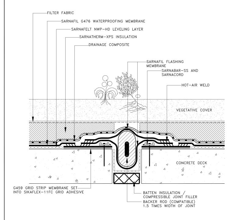
1) THE BACK OF THE G459 GRID STRIP MEMBRANE MUST BE PRIMED WITH SIKAFLEX PRIMER 449.
