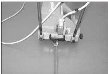
Fig. 1.6 Posicionamiento de la Guía Décor sobre el perfil
